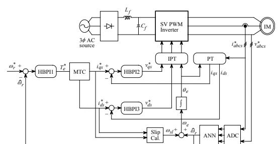
그림 3. HBPI를 이용한 유도전동기 드라이브의 제어 시스템
