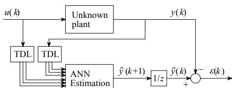
그림 5. ANN을 이용한 시스템 추정
