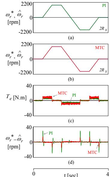
그림 12. 파라미터 변동에 대한 최대토크 응답특성( $2R_s$ )
