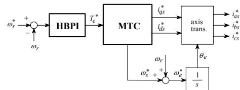
그림 2. HBPI 제어기로 이용한 최대토크 제어의 블록도
