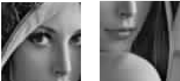
(a) 격자 잡음 (b) 계단 잡음 <그림 1> JPEG 복호 영상의 블록 현상
