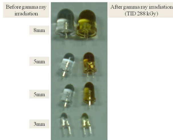
그림 1. 고휘도 백색 LED의 고선량 감마선 조사. Fig. 1. High dose-rate gamma irradiation of high luminance LED.
