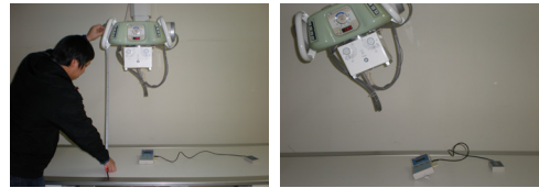
그림 1. 측정거리와 각도변화에 따른 관전압정확도 시험
