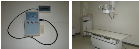
그림 2. 관전압 측정기와 진단용 방사선발생장치
