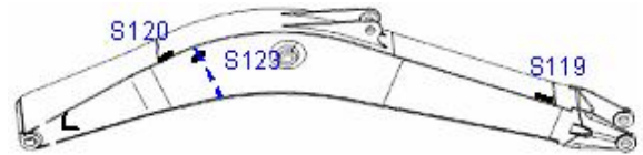
그림 2. 붐 부위의 센서 부착 위치(a). Fig. 2. Sensor positions on the boom(a).
