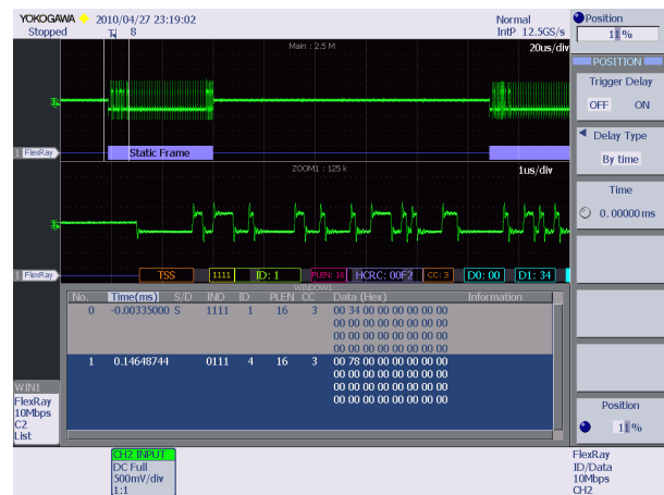
그림 15. 버스 분석기를 통한 static 전송 메시지의 확인. Fig. 15. Checking static message using bus analyzer.
