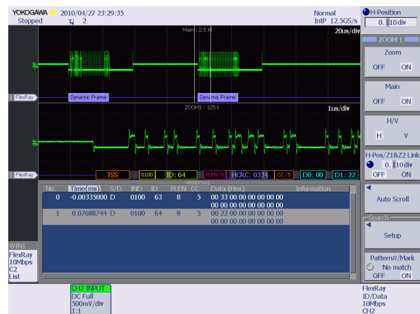
그림 16. 버스 분석기를 통한 dynamic 전송 메시지의 확인 Fig. 16. Checking dynamic message using bus analyzer
