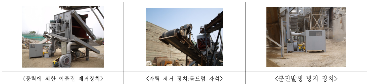
[그림 4] 이물질 제거공정의 풍력제거, 자력제거 및 분진방지 장치
