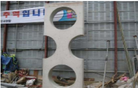
정해진 재료인 P.O. Steel을 사용하여 새로운 거푸집을 제작하는 대신 박리제를 다시 시험하기로 결정하였다. 코팅제의 경우 부분적인 보완이 불가능한 단점이 있어 기존 유성 박리제 중 토목현장에서 사용되는 고품질의 것을 시험해보기로 하였다. 그러나 위와 같이 시공할 경우 콘크리트 표면의 광택(치밀함)이 미흡하고 거칠다는 문제점이 발생하였다. 따라서 Color Pigment 비율은 다시 조정하기로 하였다.
