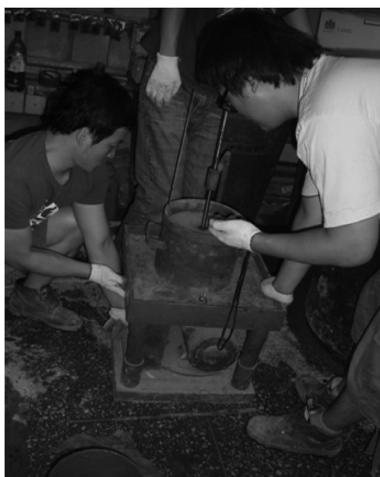
Fig. 2 Vebe time test
