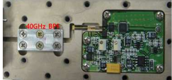
그림 8. 제작된 40 GHz PLL Fig. 8. Fabricated 40 GHz PLL
