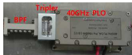
그림 15. 결합된 120 GHz 국부발진기 Fig. 15. Assembled 120 GHz local oscillator
