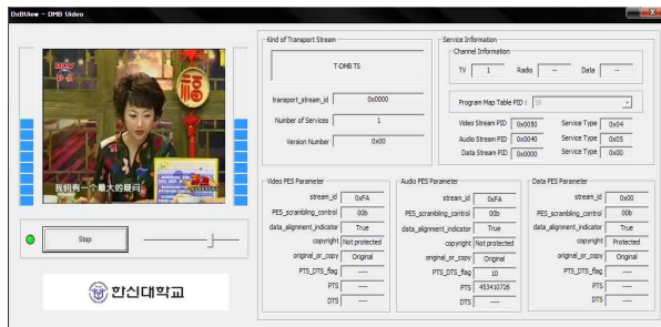
그림 7. MPEG-2 TS 분석기와 역다중화 결과화면 분석 Fig 7. The Result of MPEG-2 TS Demuxing
