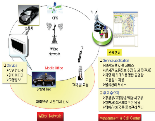
그림 1. 와이브로 기반의 텔레매틱스 시스템 서비스 구성도 Fig. 1 Wireless Telematics System service configuration architecture on WiBro
