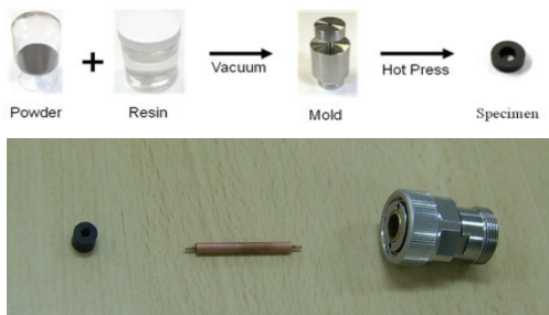
그림 1. Fe 2 O 3 물성 측정을 위한 시료제작 및 측정 Fig 1. Measurement and fabrication of samples to analyze characteristics of Fe 2 O 3
