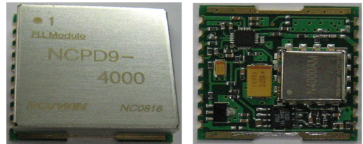
그림 13. PLL 실제 사진 Fig 13. Photograph of PLL
