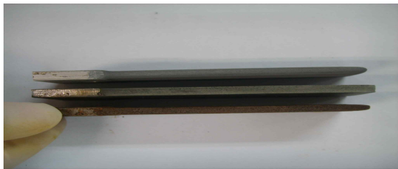
그림 9. 알루미늄을 연결하지 않았을 때의 강철판과 비교 Fig. 9. The steel sheet comparison between non-connecting and connecting aluminum
