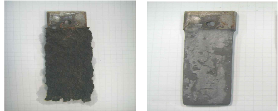
그림 6. 24시간 후 강철의 산화된 모습 Fig. 6. The corroded appearance of steel sheet after 24hours
