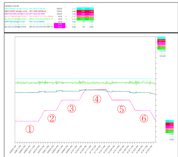
그림 14 계통병입 후 급수펌프 B 부하시험 및 조정
