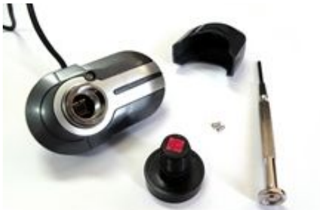
그림 4 웹캠에서의 적외선 차단 필터 제거 과정
