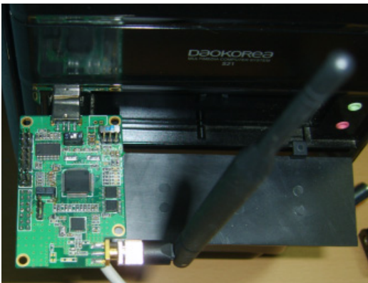
그림 3. PC와 연결한 제작된 지그비 모듈 Fig. 3 Zigbee module connected PC
