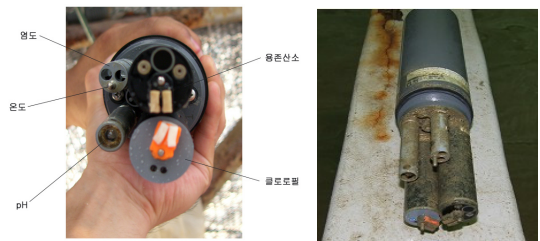
그림 2. YSI-6920V2 센서 모듈 및 센서 외관 Fig. 2 Module and exterior of YSI-6920V2 sensor
