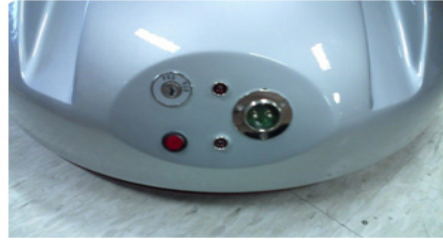
그림 9. 후면 제어 패널 Fig. 9 Control panel of back side
