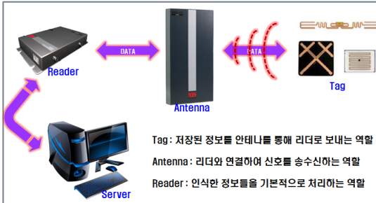
그림 2. RFID의 구성 Fig. 2 Configuration of RFID
