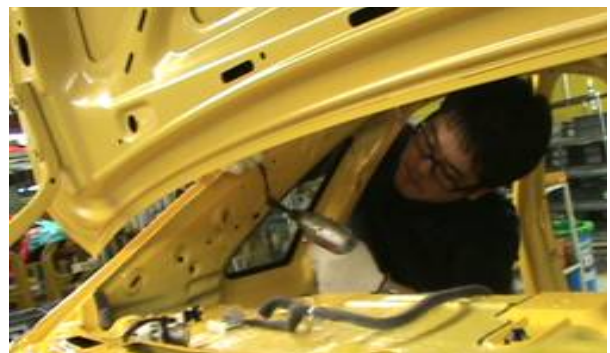
그림 3. 임팩트렌치를 이용한 부품의 장착 예
