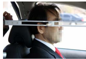
(a) 제작한 측정 장비를 이용하여 피실험자의 눈 위치 측정
