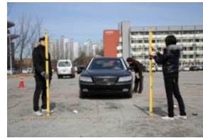
(c) 측정용 폴 두 개를 사용한 시계 한계점 측정 (Binocular FOV)
