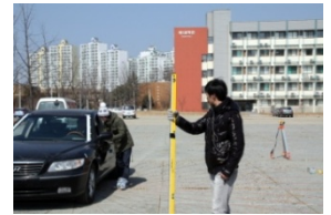
(d) 측정용 폴 한 개를 사용한 시계 한계점 측정 (Ambinocular FOV)
