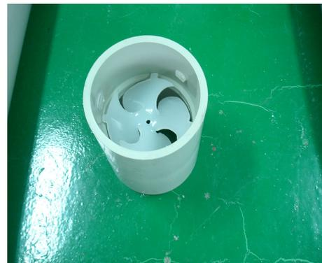
그림 4. 3차반응기 혼합 베인이 설치된 소켓
