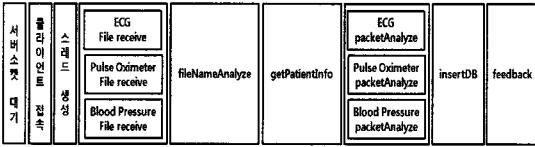
그림 13. Healthcare 서버 처리 과정 Fig. 13. Sequential Procedure at Healthcare Server
