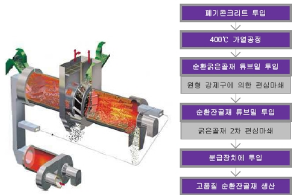
그림 8. 가열마쇄방식의 개념 및 생산 플로우
