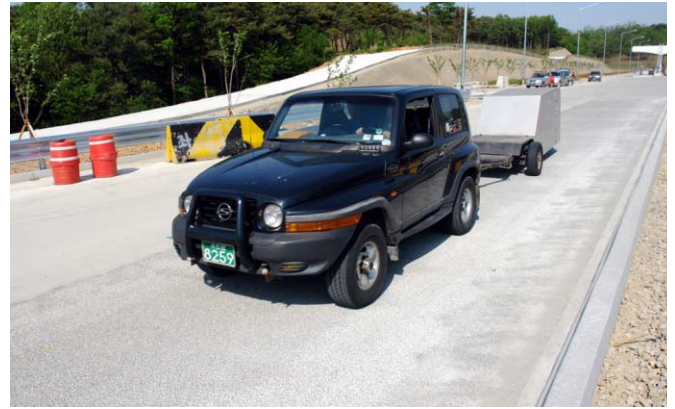
그림 25. CPX Trailer를 이용한 근접소음 측정
