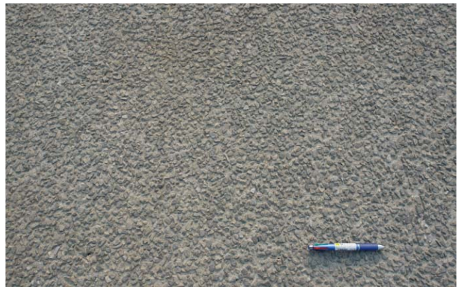
그림 1. 소입경 골재노출 콘크리트포장의 표면조직
