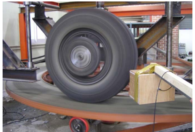
그림 4. 타이어/노면소음측정장비를 사용한 소음측정
