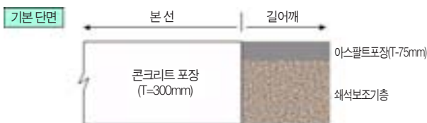
그림 9. 기존 콘크리트 포장 단면도
