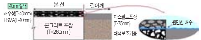
그림 10. 콘크리트 포장 40mm 절삭안
