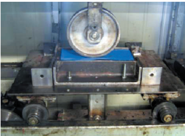
그림 2. WT 시험을 위해 공시체를 세팅하고 부직포를 덮은 모습
