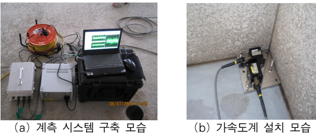
그림 5 계측을 위한 시스템 구성 및 가속도계 설치
