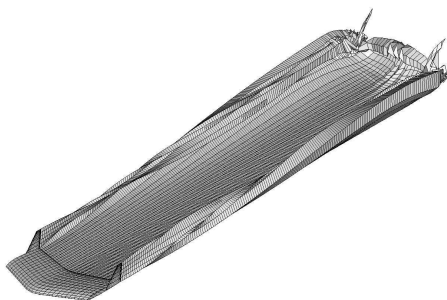
Fig. 14. 비정상 급가속운동에 의한 후류형상
