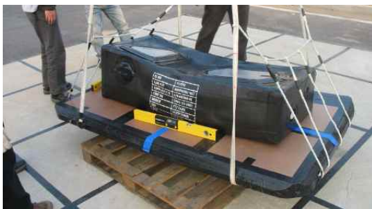
Fig. 8. Step 3 : Pallet Leveling
