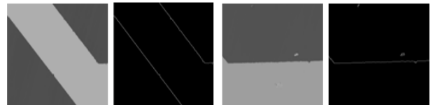
(a) 그레이 레벨 영상 A (b) 캐니 에지 추출 영상 A (c) 그레이 레벨 영상 B (d) 캐니 에지 추출 영상 B
