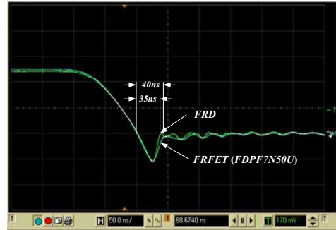
그림 6 FRD와 FRFET의 Trr 파형 Fig. 6 Trr waveforms of FRFET and FRD.
