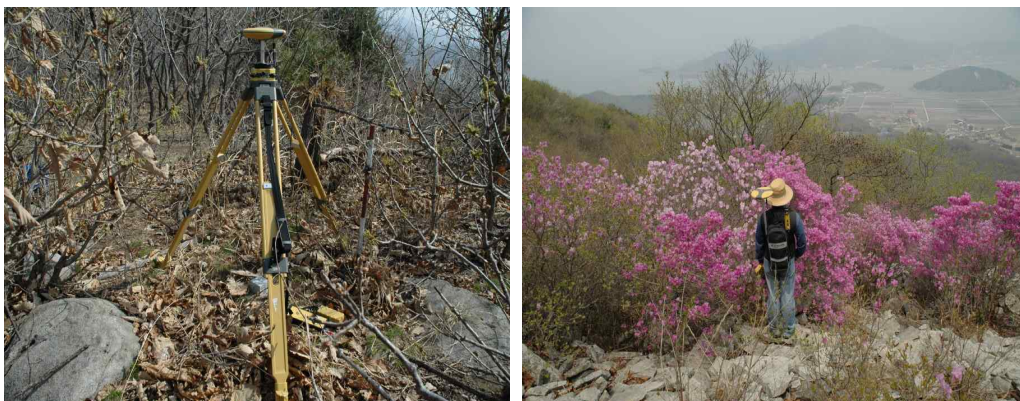
FIGURE 4. 강화군 석모도일대 GPS-RTK 측량 현장. 기지국(왼쪽) 및 이동국(오른쪽)
