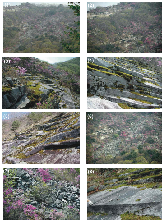
FIGURE 6. 제1채석흔적지(1) 및 제2채석흔적지(2) 전경과 비교적 두께가 얇은 판상조개짐구조를 보이는 암반(3, 4, 5). 채석후 부서진 암편(6, 7) 그리고 부존 가능량 산정을 위한 실측전경(8).
