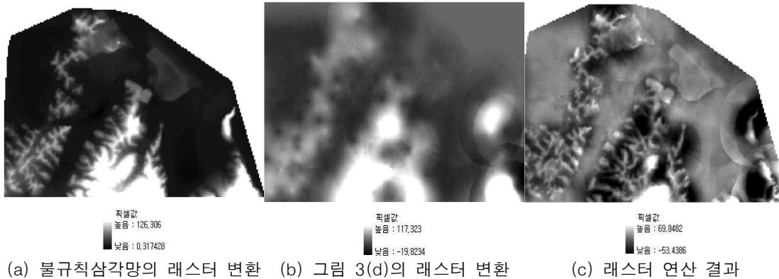
(a) 불규칙삼각망의 래스터 변환 (b) 그림 3(d)의 래스터 변환 (c) 래스터 연산 결과
