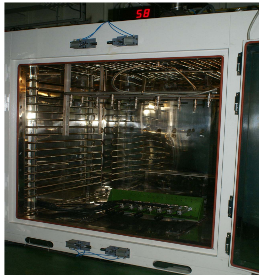
그림 8 공기압 실린더 가속시험 평가장비
