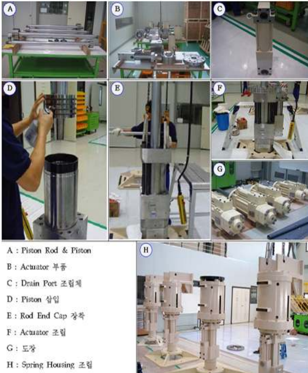
그림 6 원자력발전소 터빈출력 구동장치 조립
