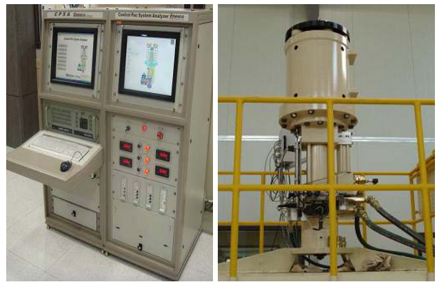
그림 8 시험장치 제어반 및 Test mechanism
