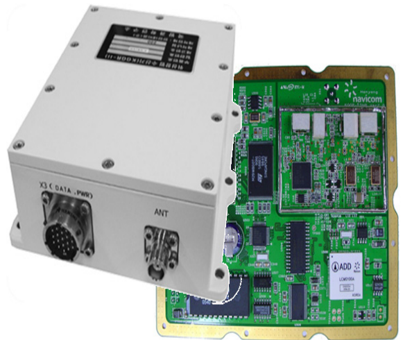
Fig. 2. 다중모드 위성항법수신기 외형과 내부
