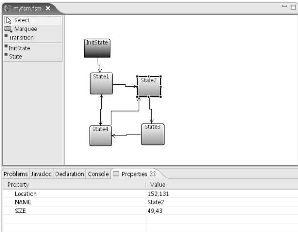
(그림 9) NanoCASE 상태 다이어그램 편집창
