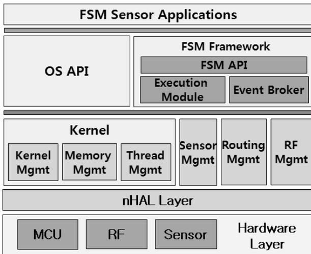
(그림 4) NanoQplus상에서의 상태머신 프레임워크 구조
