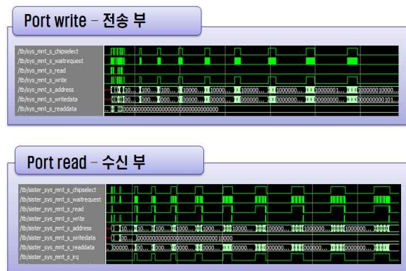
그림 23. MAINTENANCE Write 송신부 및 수신부 결과
