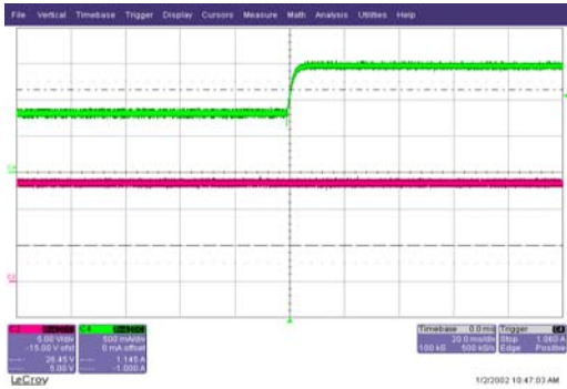
Fig. 12. Output Voltage Waveform (1/2) Min Load : 0.81A, Max Load : 1.55A
