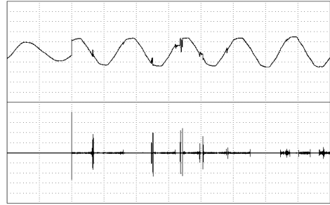
상 : 전원 전압 [200 V/div, 10 ms/div] 하 : 아크 전압 [ 2 V/div, 10 ms/div]
