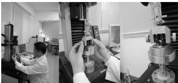
Fig. 3. Universal Testing Machine (Instron 8841)을 이용한 실험
