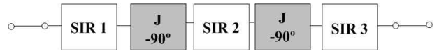
그림 5. 광대역 대역통과 필터의 J-인버터 등가회로 Fig. 5. Equivalent circuit of a J-inverter with broad BPF.
