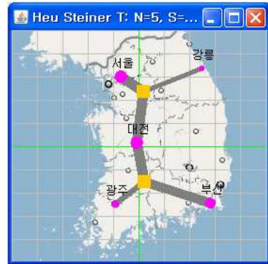
그림 6. 스타이너 트리를 이용한 우편물 이동 방법 Fig. 6. Mail distribution method using Steiner Tree.
