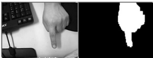
그림 1. 살색정보를 이용한 손 영역 추출. Fig. 1. Hand area detection using skin color.
