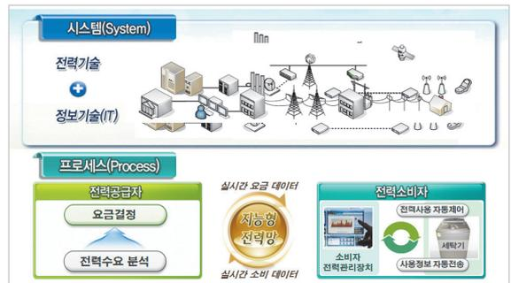
그림 1 | Smart Grid 시스템 및 프로세스
