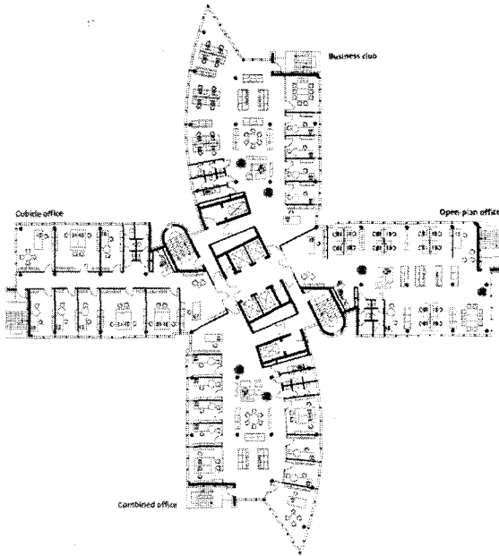
<그림 3> 초고층 사무공간 모듈과 리스스팬의 예 (Sigma Office Building)
