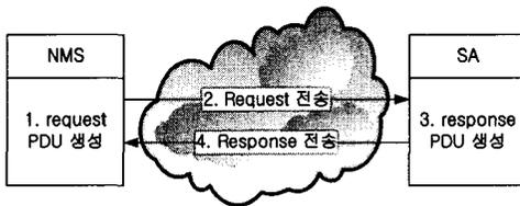
그림 3. SNMP 처리 과정
